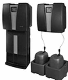
**Компактная установка для производства и дозирования диоксида хлора** методом, основанном на реакции между 7,5% хлоритом натрия и 9% соляной кислотой, с емкостями для химических реагентов.
